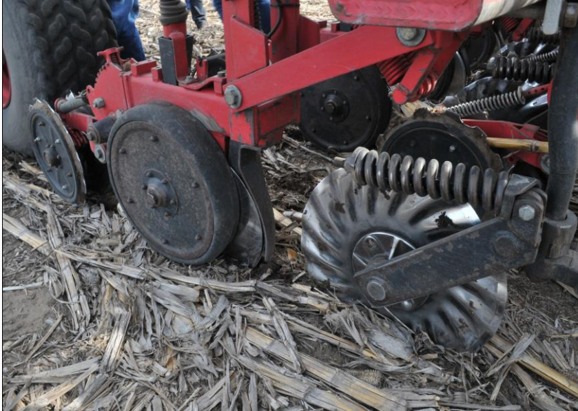
Foto 5.2 - Agregat complex pentru lucrarea solului în sistem zero lucrări (no-tillage) (USAMV Iași)
