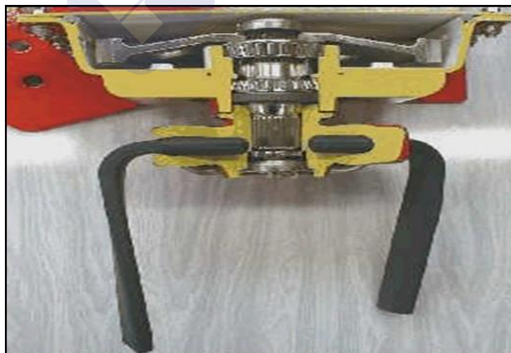
Figura 4.22 - Organ de lucru al grapei cu colți verticali rotativi
