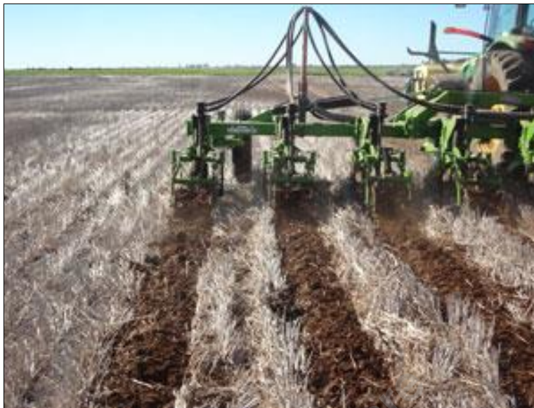
Foto 5.1 - Echipament pentru lucrarea solului în benzi (47)
