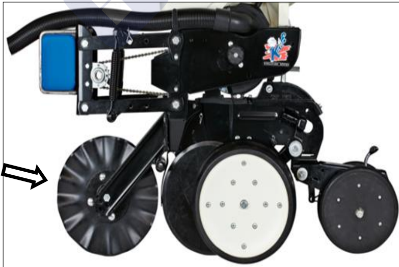
Foto 13.3 – Secție de semănat cu discuri offset
