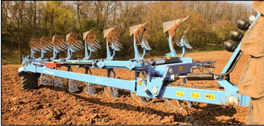
Foto 4.6 – Plug reversibil cu cormane lamelare
