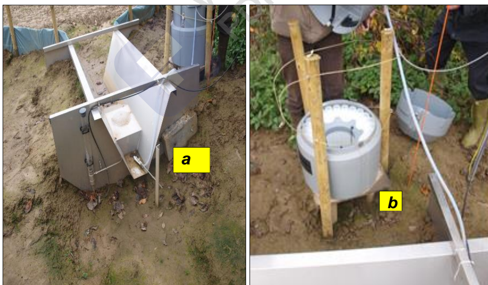
Foto 12.5 - Controlul eroziunii solului pe bazine hidrografice: a - deversor; b - dispozitiv pentru recoltat probe de turbiditate
