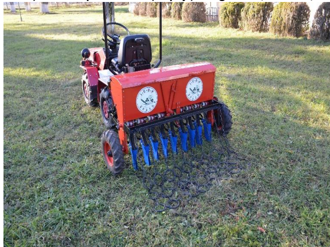
Mașina de supraînsămânțat pajiști degradate, MSPD 2,5
