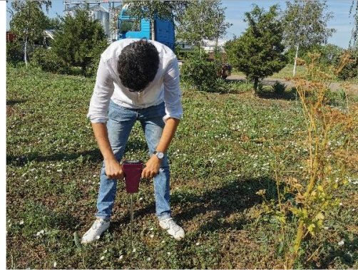
Aspect din timpul efectuării măsurătorilor rezistenței solului la penetrare în locația partenerului P3-MORAR PAN COM SRL
