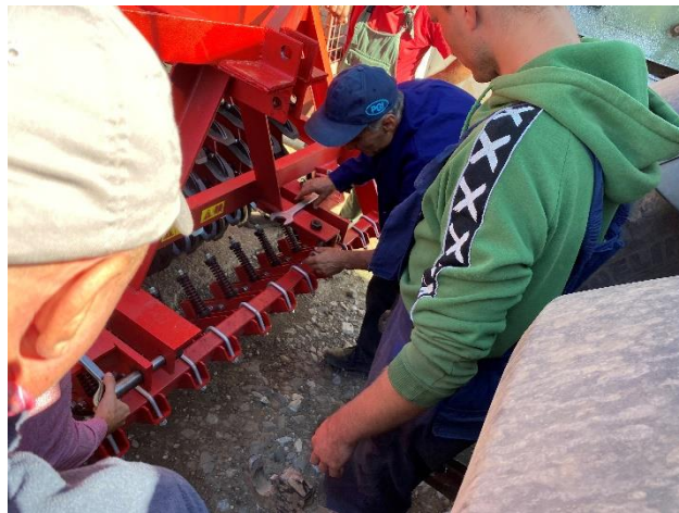
Verificarea cuplării echipamentului la tractorul de 120CP pe roți
