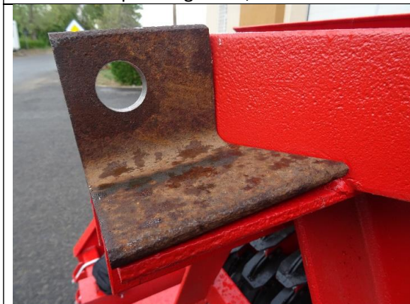
Poziționarea reperului "Element cuplare dr. SAP1,5-1.1.25" pe cadru sudat SAP1,5-1.0A
