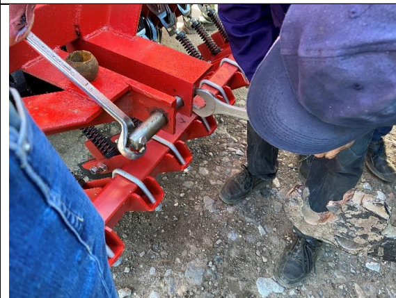
Poziționarea reperului " Bolț SAP1,5-8.1" pe ansamblul general SAP1,5-0A
