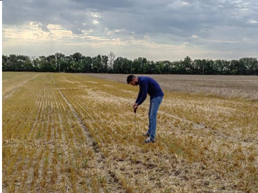
Aspect din timpul efectuării măsurătorilor rezistenței solului la penetrare în locația partenerului P2-CEREALFLOR SRL
