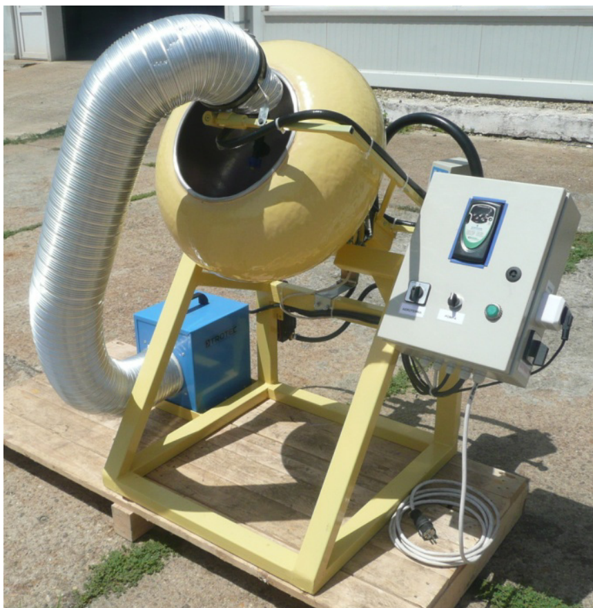
Fig. 1. Echipament tehnic pentru tratarea semințelor ETS .
