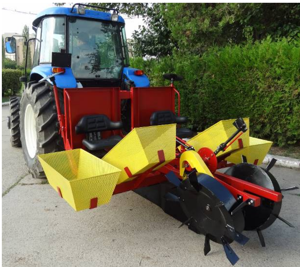
Fig. 1. Echipament tehnic de înființat perdele agroforestiere MPP .
