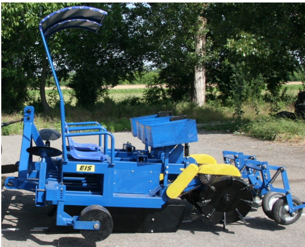
Fig. 1. Echipament tehnic de înființat salcie energetică EIS .
