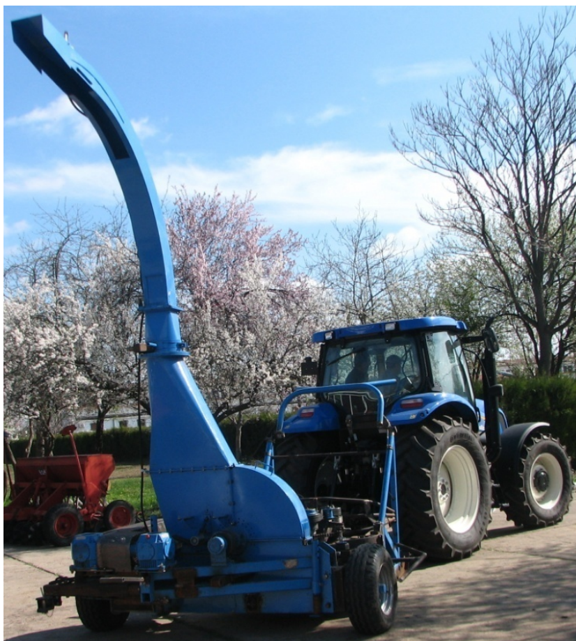
Fig. 1. Echipament de tăiat și tocat salcie energetică ETSE .
