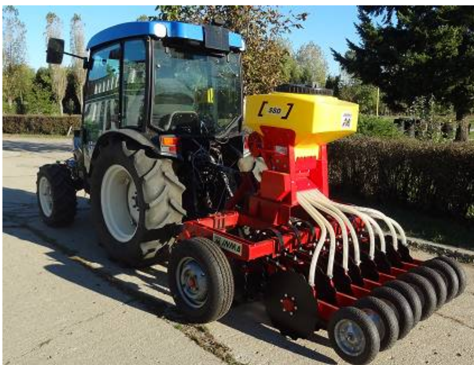
Fig. 1. Semănătoare pentru semănat direct culturi agricole în rânduri dese – SSD.
