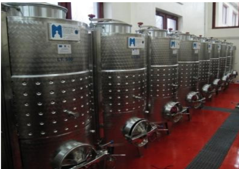
Fig. 2. Cisterne termostatate de fermentare.
