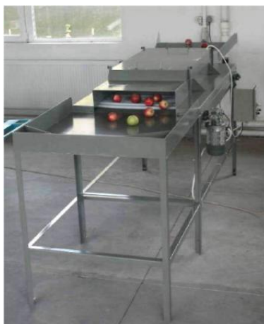
4. Instalație de decontaminare a suprafețelor exterioare ale produselor horticole IDPH
