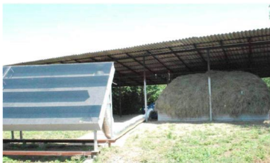
3. Instalație automatizată pentru depozitarea temporară a produselor horticole IDT
