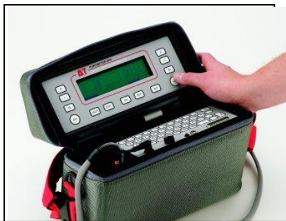
Porometru (Sistem Delta T 4) pentru determinarea conductanței stomatale
