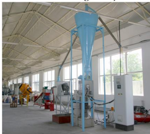
Omogenizare-transport - dozare și separare magnetică - mărunțire - peletizare
