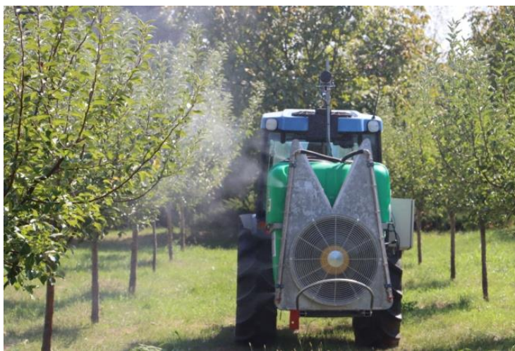
Echipamentul de stropit dotat cu sistem automat de detectare a culturii țintă
