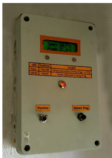
Dispozitiv de comandă programată în prealabil, a convectoarelor
