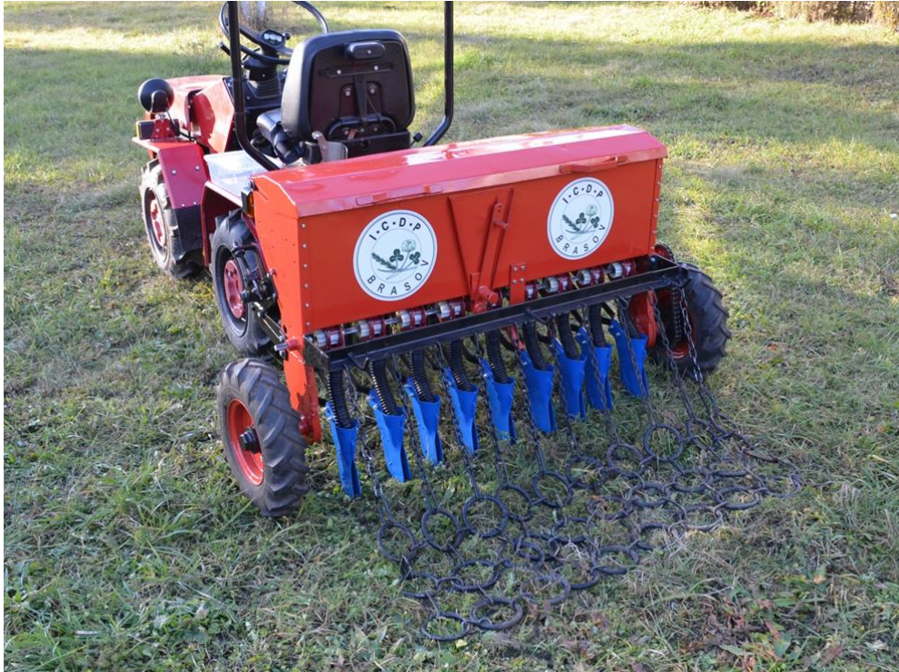
Agregat format din tractor pe roți de 9,5 kW și mașina de semănat câmpuri experimentale MSCE 9
