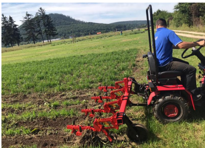
Agregat format din tractor pe roți de 9,5 kW și echipamentul de prășit EP4
