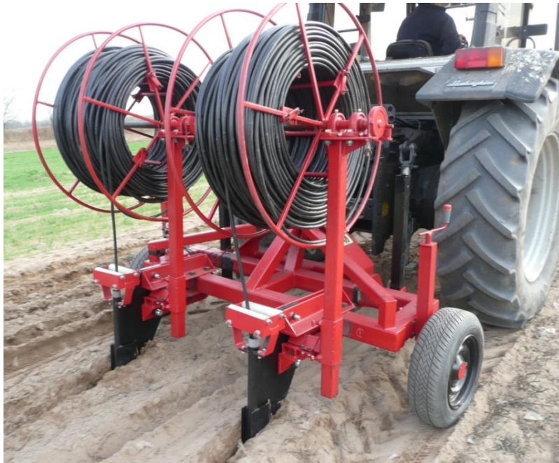
Echipamentul tehnic pentru amplasarea în sol a furtunurilor de irigare / fertirigare
