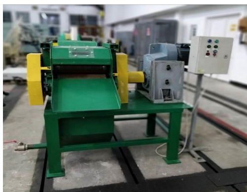
Model experimental de instalație presare tulpini sorg (IPST)
