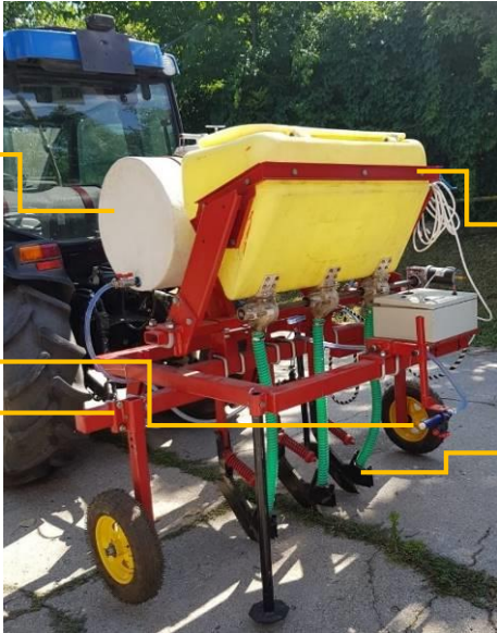
Echipamentul combinat pentru tratarea biologică a solului cu bioinoculanți microbieni
