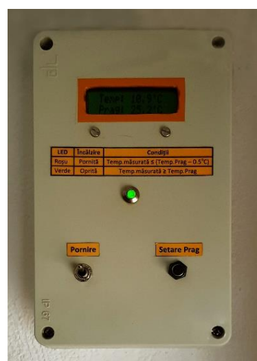
Dispozitiv de comandă programată în prealabil, a convectoarelor
