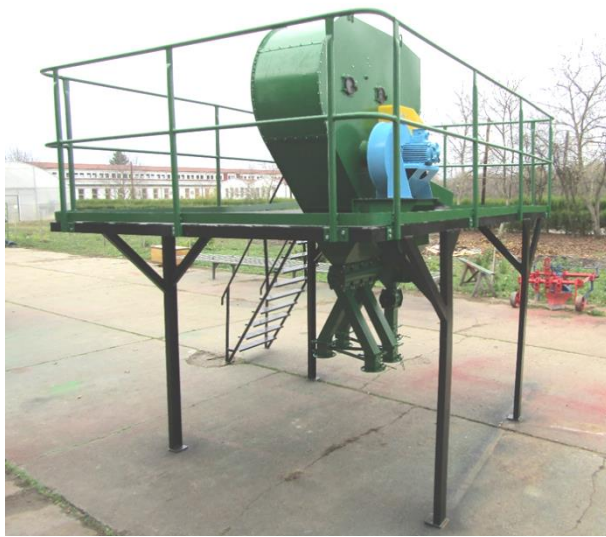
Modul de condiționat semințe pentru speciile legumicole MCSL 1-Sortator aerodinamic MCSL 1.0; 2-Sistem evacuare sorturi MCSL 2.0; 3-Platformă lucru MCSL 3-0; 4 - Instalație electrică MCSL 4-0
