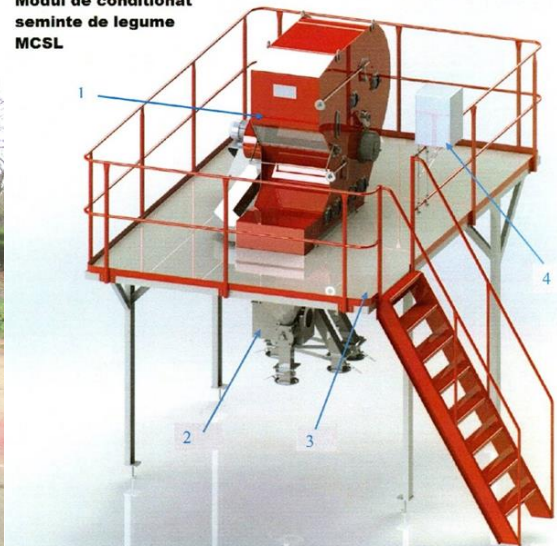
Modul de condiționat semințe pentru speciile legumicole MCSL 1-Sortator aerodinamic MCSL 1.0; 2-Sistem evacuare sorturi MCSL 2.0; 3-Platformă lucru MCSL 3-0; 4 - Instalație electrică MCSL 4-0
