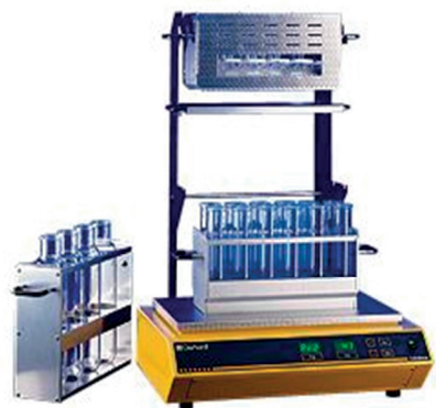
Figura 78 – Unitate de mineralizare Turbotherm TT 265
