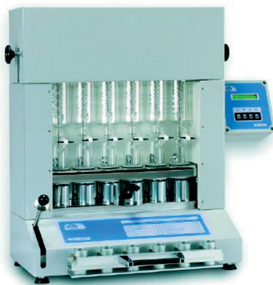
Figura 81 – Extractor cu 6 posturi Det Gras N6p
