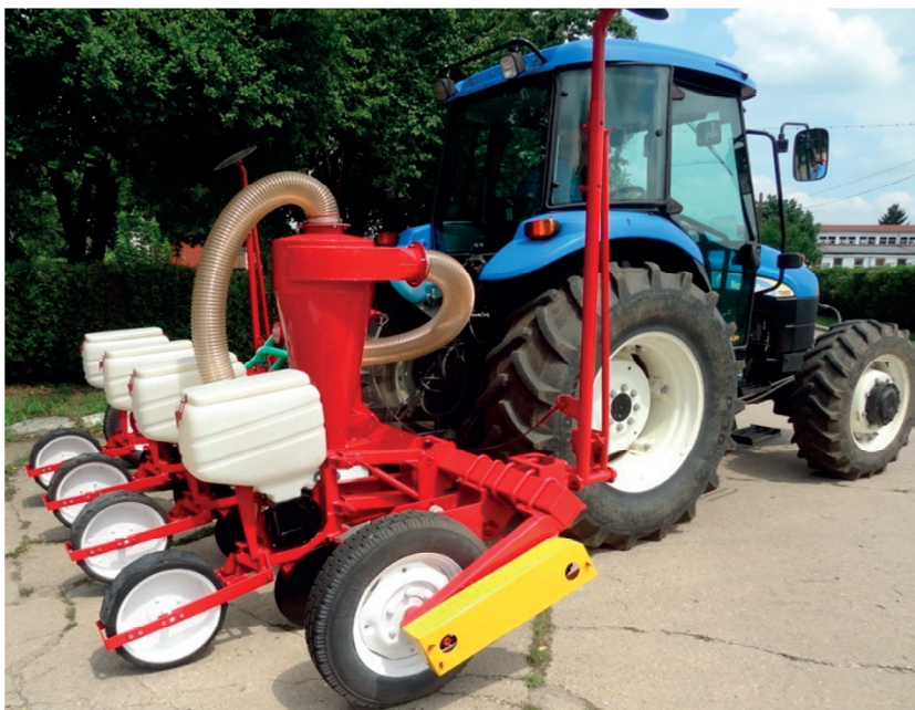
Figura 113 – Sistem eco-inovativ prevăzut cu „deflector” pentru înființarea culturilor de plante prășitoare - SED
