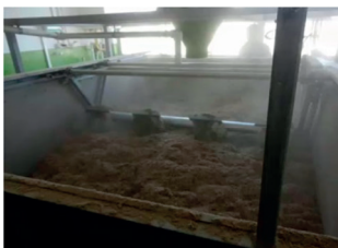
Din ciclul desprăfuitor, deșeurile tocate ajung în cuva de inox
