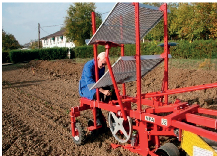
Figura 110 – Echipament multifuncțional de înființat culturi de plante medicinale pe suprafețe reduse - MPA
