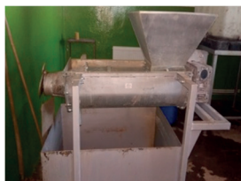
Storcerea materialului biodegradat cu ajutorul prese conice și separarea celor două produse finite
