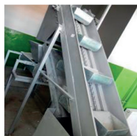
Evacuarea tocăturii din bazin cu elevatorul cu cupe, în storcător
