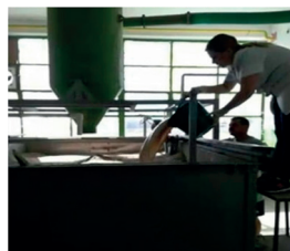
Adăugarea de apă și bioinoculul cu microorganismele lignocelulozolitice pentru stimularea biodegradării
