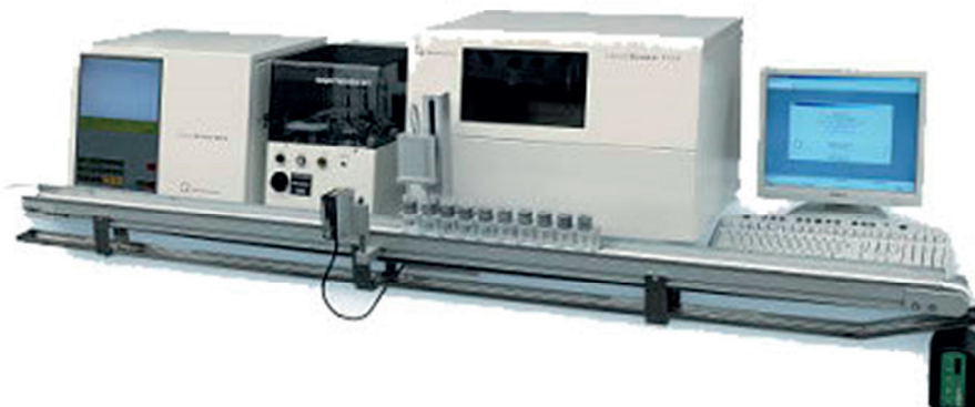
Figura 129 – Combiscope FTIR 400, Advanced Instruments utilizat în analiza calitativă a laptelui
