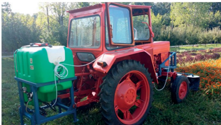
Fig. 1. Echipament pentru combaterea termică a buruienilor
