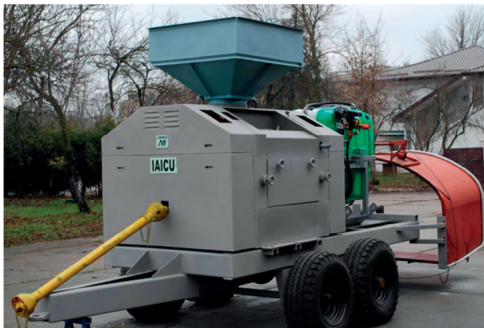
Fig. 1. Instalație de aplatizat în vederea însilozării cerealelor în stare umedă - IAICU
