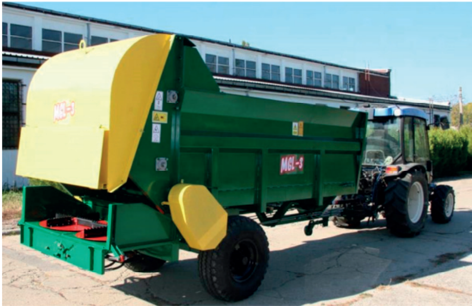
Fig. 1. Mașină pentru distribuit îngrășăminte organice solide, în benzi - MGL 3
