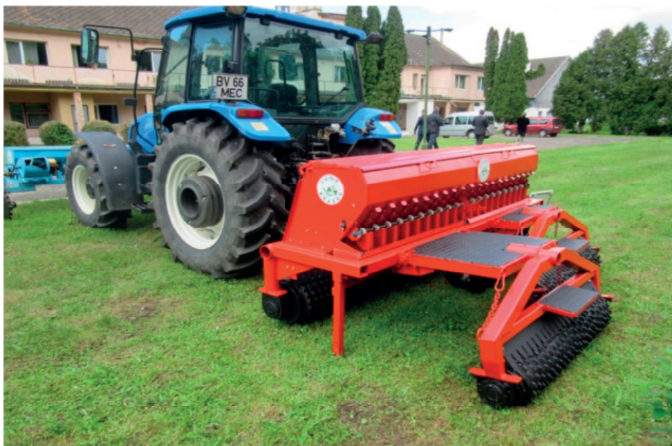
Fig. 1. Agregat format din tractor pe roți de 81 kW și mașina de semănat pajiști modernizată - MSPM-2,5
