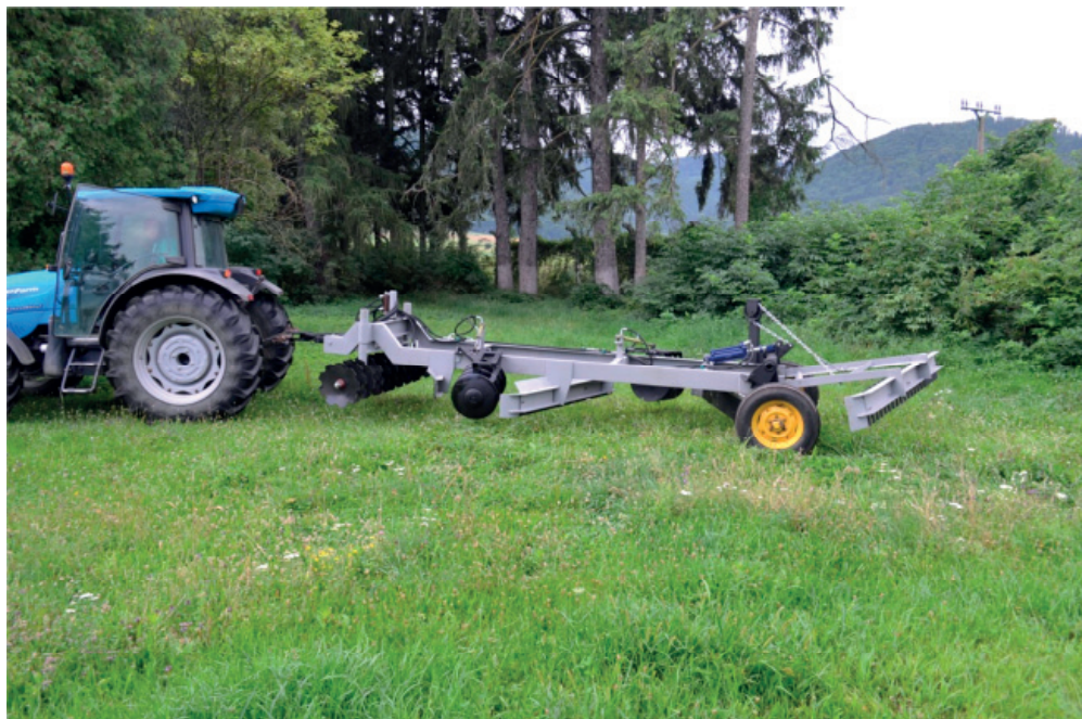
Fig. 1. Agregat format din tractor pe roți de 81 kW și Rindeaua-Greder de Pajiști - RGP-2,0
