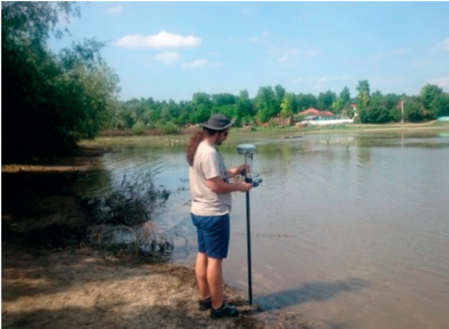
Fig. 2. Realizarea măsurătorilor topobatimetrice pe lacul de acumulare Solești: a) din barca, b) de pe mal
