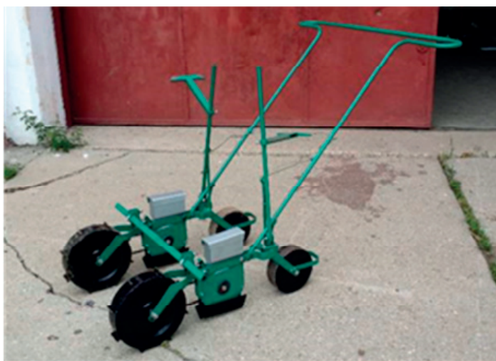
Fig. 1. Echipament de semănat pentru plante medicinale și aromatice
