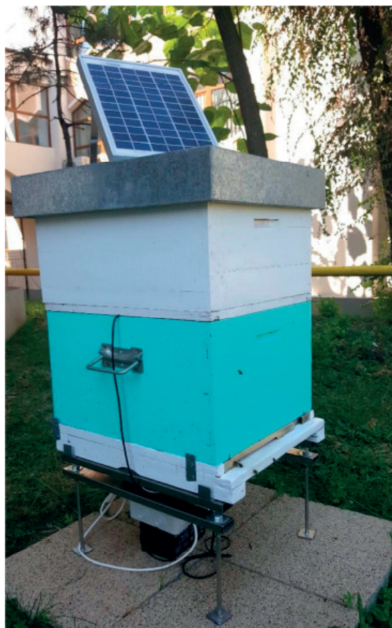
Fig. 1. Familie de albine monitorizată cu sistemul electronic SimBee®
