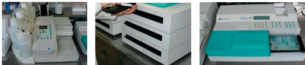
Fig. 1. Linie ELISA: spălător de plăci (stânga), incubator de plăci (mijloc), cititor spectrofotometric (dreapta)
