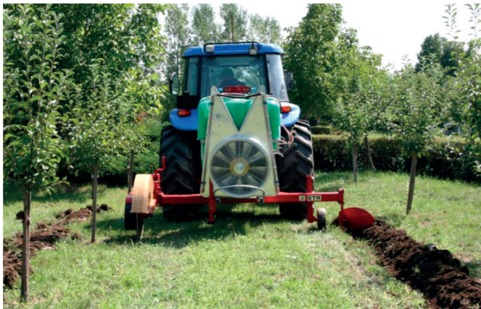
Fig. 1. Echipament tehnic pentru lucrarea solului pe rândul de pomi fructiferi, concomitent cu tăierile de rădăcină pentru moderarea creșterii de lăstari și fertilizarea foliară de precizie - ETR -
